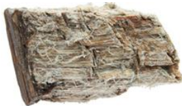
Amosite (brown asbestos)
